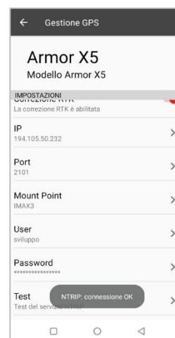
Figura 31: Test connessione servizio NTRIP avvenuto con successo
